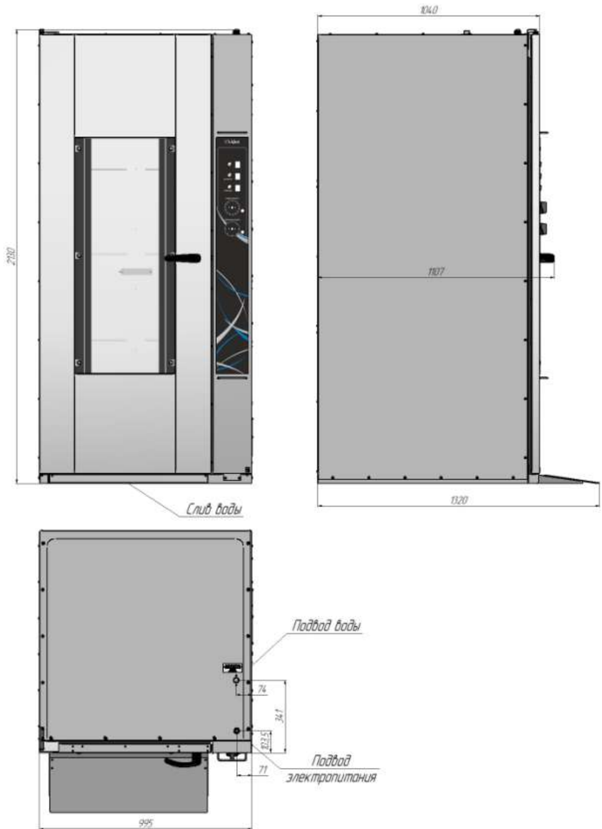
Рис.2 Шкаф расстоечный тепловой ШРТ-18М.
