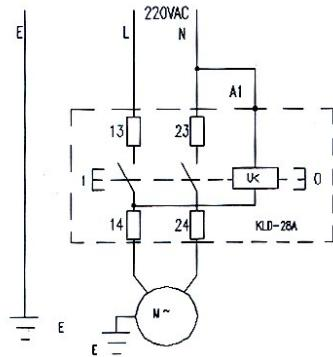
KLD: Выключатель      M: Двигатель
